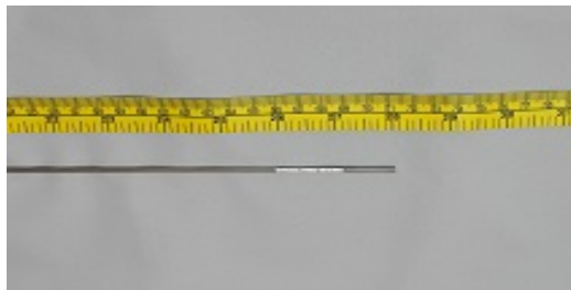
※写真④ ステンレス鋼ロッド(Φ 約 0.2cm x 約 71cm)
